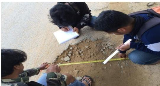
Gambar 3: Bentuk pengukuran kerusakan jalan
